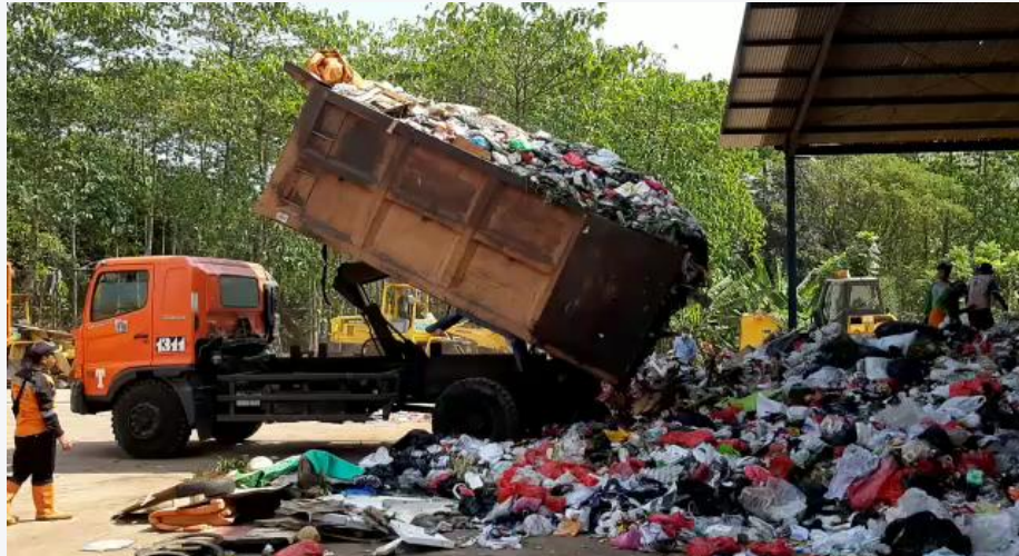
Unloading sampah dari truk ke area pre treatment
